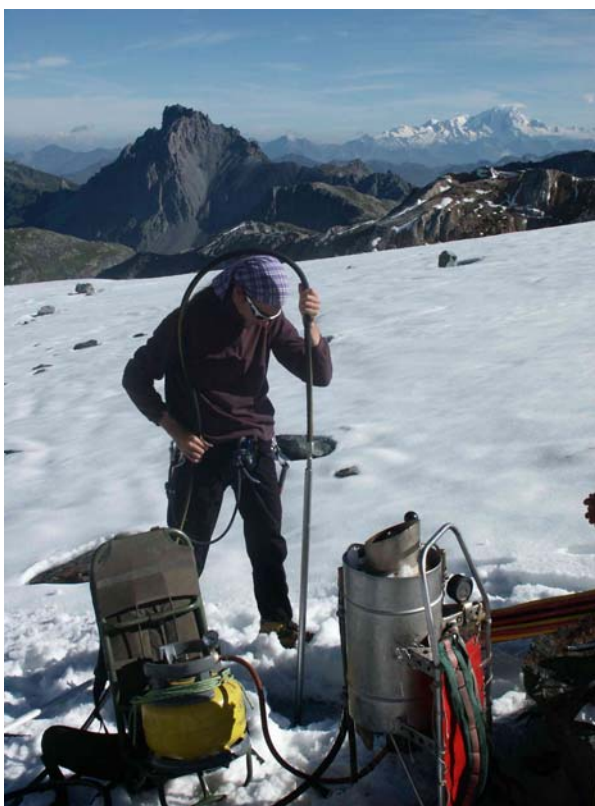
Figure 2 : Forage à la vapeur au glacier de Gébroulaz, le 15 Août 2007. Photo :C. Vincent
