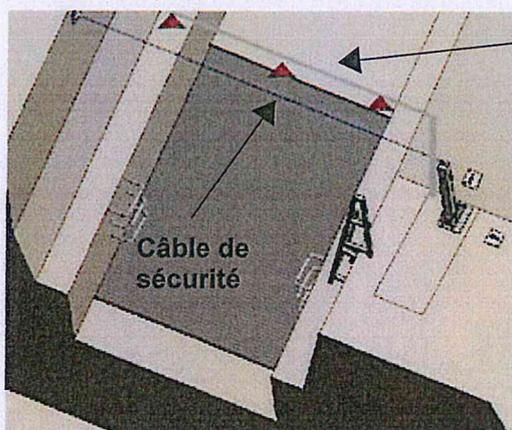
Second câble distant d'1m50 au maximum du câble de sécurité et muni de Fireflys
